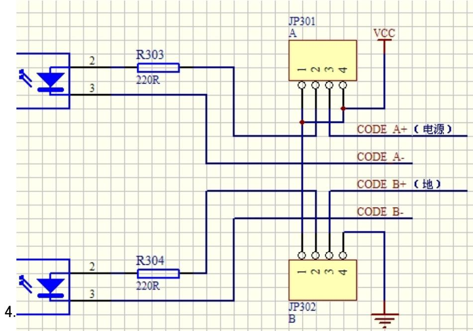
Code\_A、Code\_B、Code\_A、Code\_B 四路脉冲输入信号的用法
